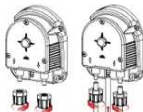
Figura 6/ Extracción de los Racores
