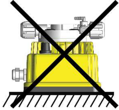
Şekil 11 Pompa Yanlış Montaj Pozisyonu
