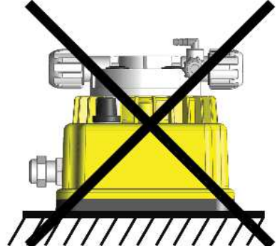
Şekil 6 Pompa Yanlış Montaj Pozisyonu
